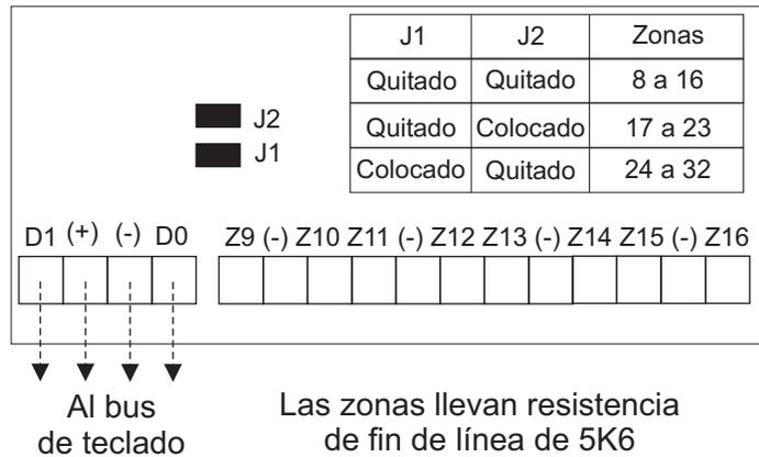
Luego setear los jumpers J1 y J2 se debe alimentar el expansor, una vez energizado habilitar el expansor según corresponda.
